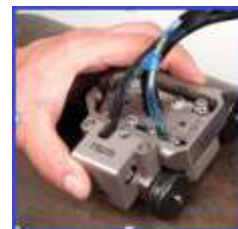
Đầu dò phased-array - Hydroform - CTAT
