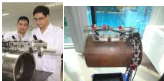
Thử nghiệm siêu âm mảng điều pha phased-array thực hiện trong phòng thí nghiệm của CTAT
